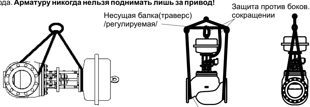
Рис. 10: Пример использования такелажных средств при манипулировании с устройством
