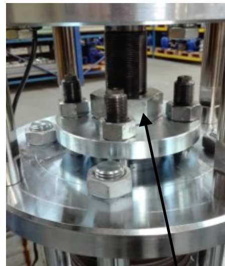
Blokovaná pružina při demontáži PV v dělicí rovině
