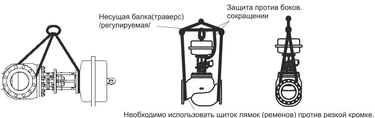
Пример использования такелажных средств при манипулировании с устройством
