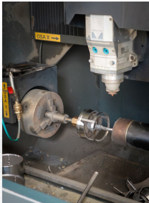
Řezání regulačních částí kuželek laserem
